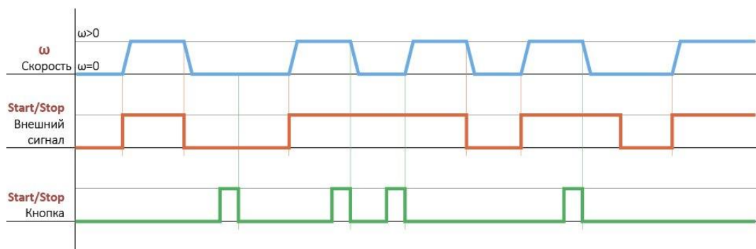
Рис.6. Диаграмма согласной работы внешнего сигнала «START/STOP» и встроенной кнопки.
