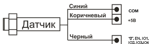
Рис. 11. Пример подключения концевой датчика типа NPN NO к блоку.
