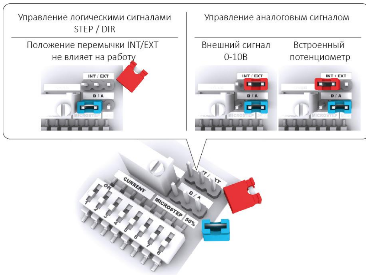
Рис. 1. Положение переключек выбора режима и способа управления
