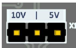
Рис. 13 – переключка для выбора диапазона аналогового сигнала.
