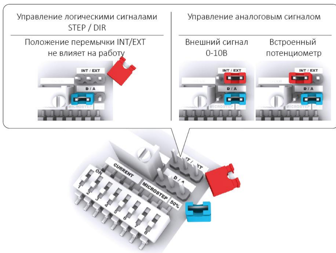
Рис. 1. Положение перемычек выбора режима и способа управления
